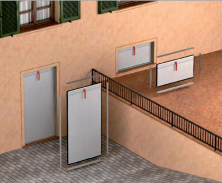
Das Flutschott INTEGRA dient zum vollständigen, schnellen Verschließen von Kellerfenstern und Kellertüren sowie von Lichtschächten bei Hochwasser und Starkregen. Mit dem Schließhebel wird das Flutschott fest in die zu schützende Öffnung gepresst und somit nach allen vier Seiten hin abgedichtet.
