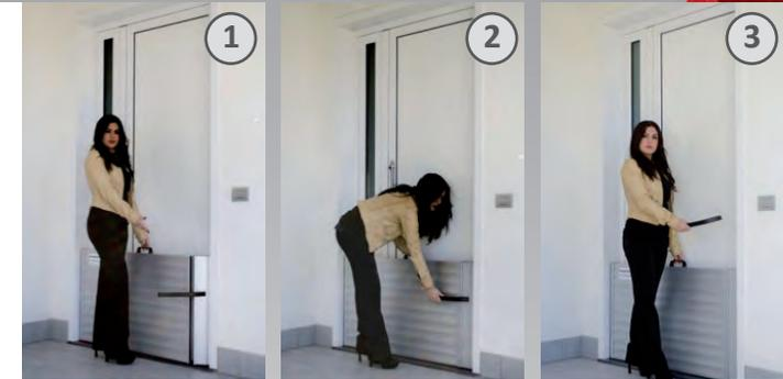
1. Das Flutschott auf der Türschwelle bzw. Fensterbrüstung absetzen und seitlich mit Tür- oder Fensterlaibung in Kontakt bringen (falls die Laibungstiefe nicht ausreicht, Winkelprofile anbringen). Der Schließhebel muss in Richtung des erwarteten Wassers eingesetzt werden. Die linke Hand auf den oberen Rand des Flutschotts legen und dieses fest nach unten drücken, bis die untere Dichtung perfekt mit dem Boden abschließt.
